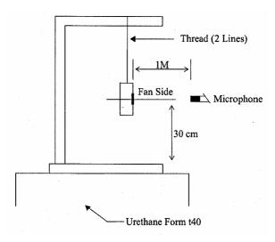
1 METER FROM MICROPHONE TO FAN INTAKE
